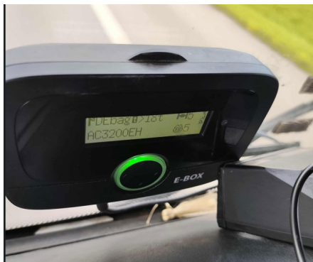
Рис. 3.6. Приклад бортового обладнання, що застосовується для стягнення плати за проїзд в країнах ЄС (надано міжнародним автомобільним перевізником вантажів)
